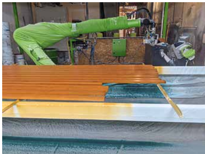
Die Lackierung übernimmt ein Roboter mit einer außergewöhnlichen Reichweite von 3,6 Metern.
