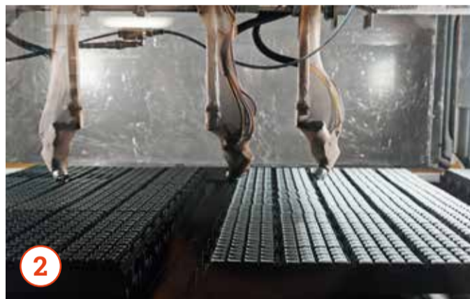
2 Die Bauteile werden auf zwei Flächenspritzautomaten lackiert.
