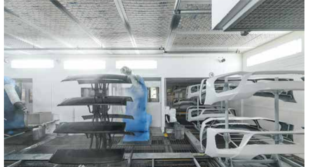
In der Serienlackierung werden auf den Linien täglich rund 2.500 Kunststoff-Außenhautteile in bis zu 45 Serien- und 200 Individualfarben lackiert.
