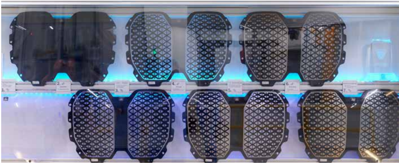
In sieben Prozessschritten vom Spritzguss-Bauteil zur unverwechselbaren und funktionalen „Doppelnieren“: In der Fertigung ist es wichtig, dass nach jedem Schritt alle relevanten Qualitätsmerkmale geprüft werden.
