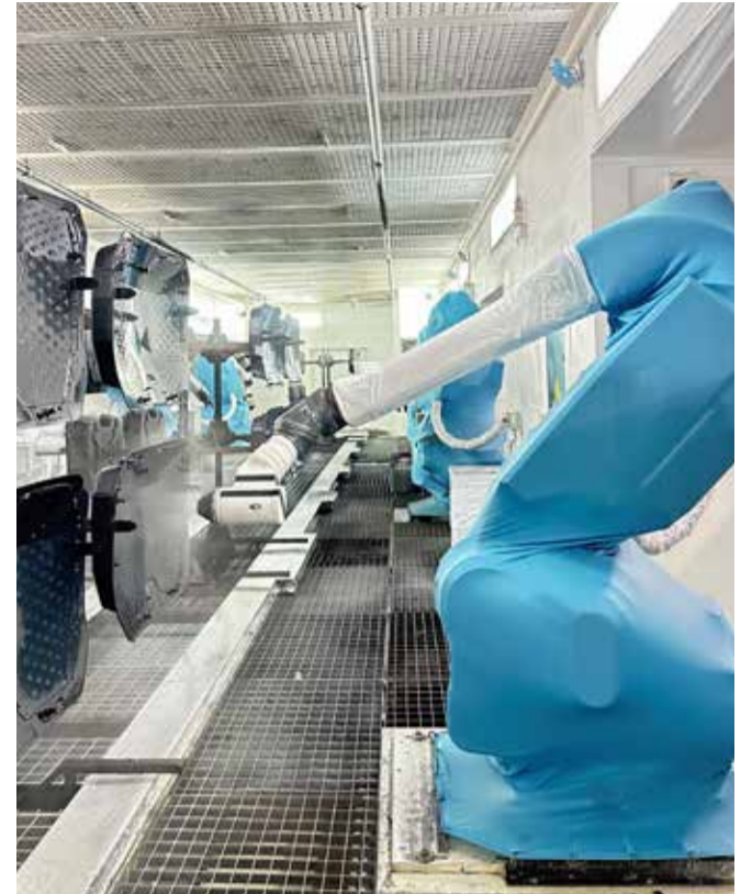
Um die Bauteile langfristig zu schützen, applizieren Roboter einen Schutzlack und versiegeln die Kantenbereiche.
