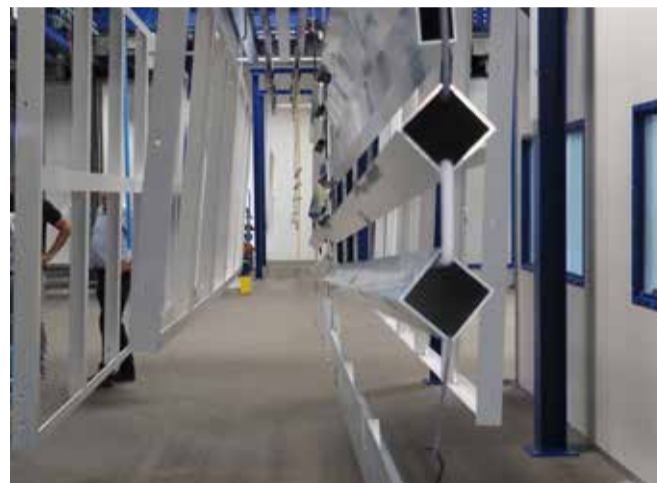
In der Anlage können Bauteile bis zu 3 m Höhe, 2,5 m Breite und 10 m Länge beschichtet werden. Foto: Redaktion
