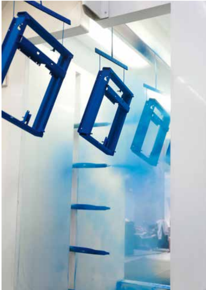
Die Beschichtungen werden entweder in der Automatikkabine, durch einen Beschichtungsroboter oder manuell durchgeführt – je nach Komplexität und Stückzahl der Werkstücke.
