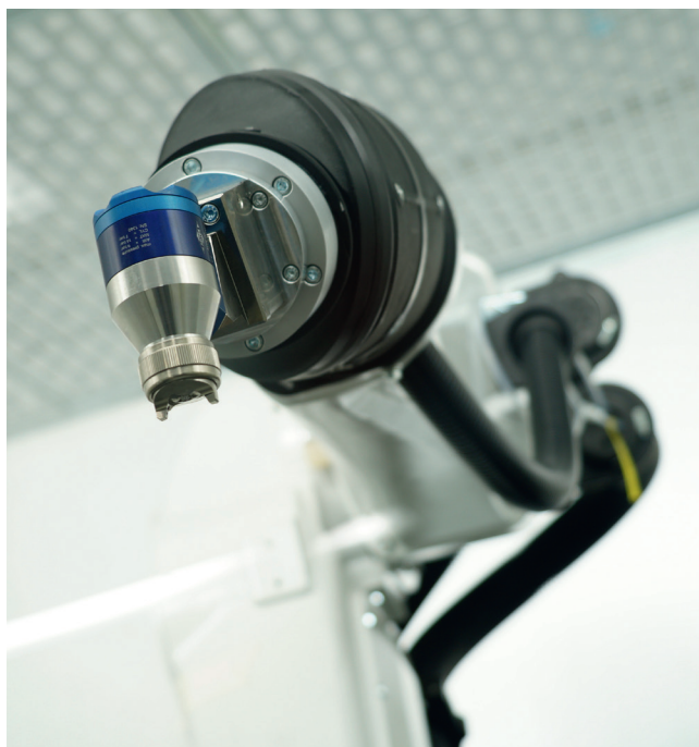
Die Lackierung erfolgt per Roboter in den beiden parallel angeordneten Lackierkabinen.
