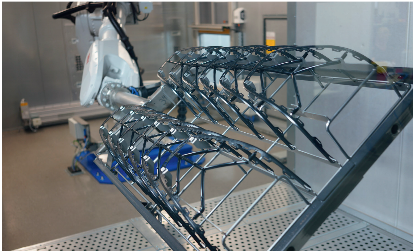
Ein großer Sechssachs-Handlingsroboter ist in der Peripherie aller relevanten Lackierprozessschritte installiert: Er befördert die Träger zu nächst zum Trockeneisstrahler und dann in eine der beiden möglichen Lackierpositionen.
