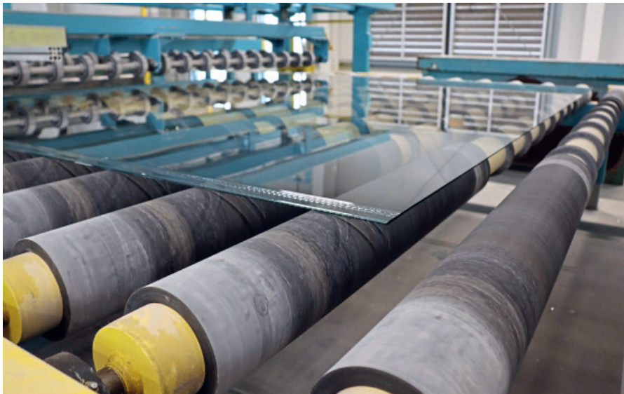
Nach mehreren hundert Metern Produktionslinie kommt am Ende tatsächlich Flachglas auf dem Band an.
