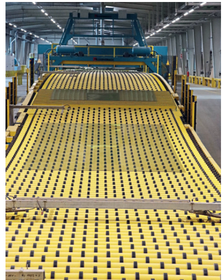
Große Glasformate benötigen entsprechend große Transportbänder und Hallen.
