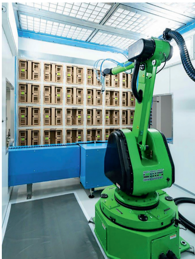
Blick in das neue Technikum des Lohnbeschichters, in dem u.a. ein Lackierroboter installiert ist. Foto: Redaktion, Jochen Kratschmer
