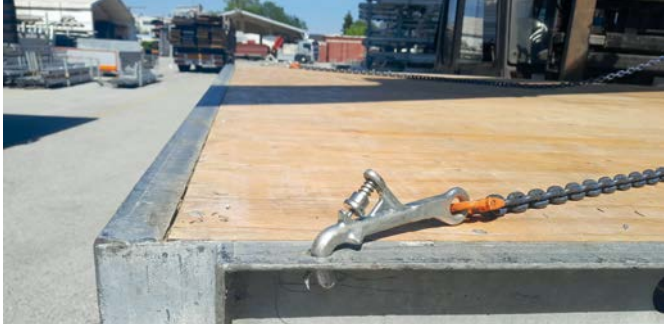
Mit dem Lochhaken ist keine weitere Sicherung der Bauteile nötig.
